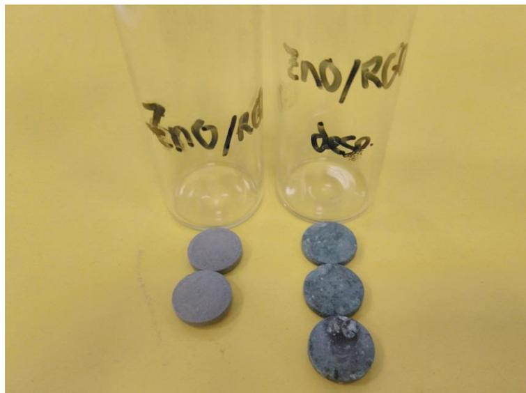
**Figura 16. Comparación de las pastillas de ZnO/RGO antes de realizar los ensayos de fotocatalisis (izquierda) y después de realizar los ensayos de fotocatalisis (derecha).**
