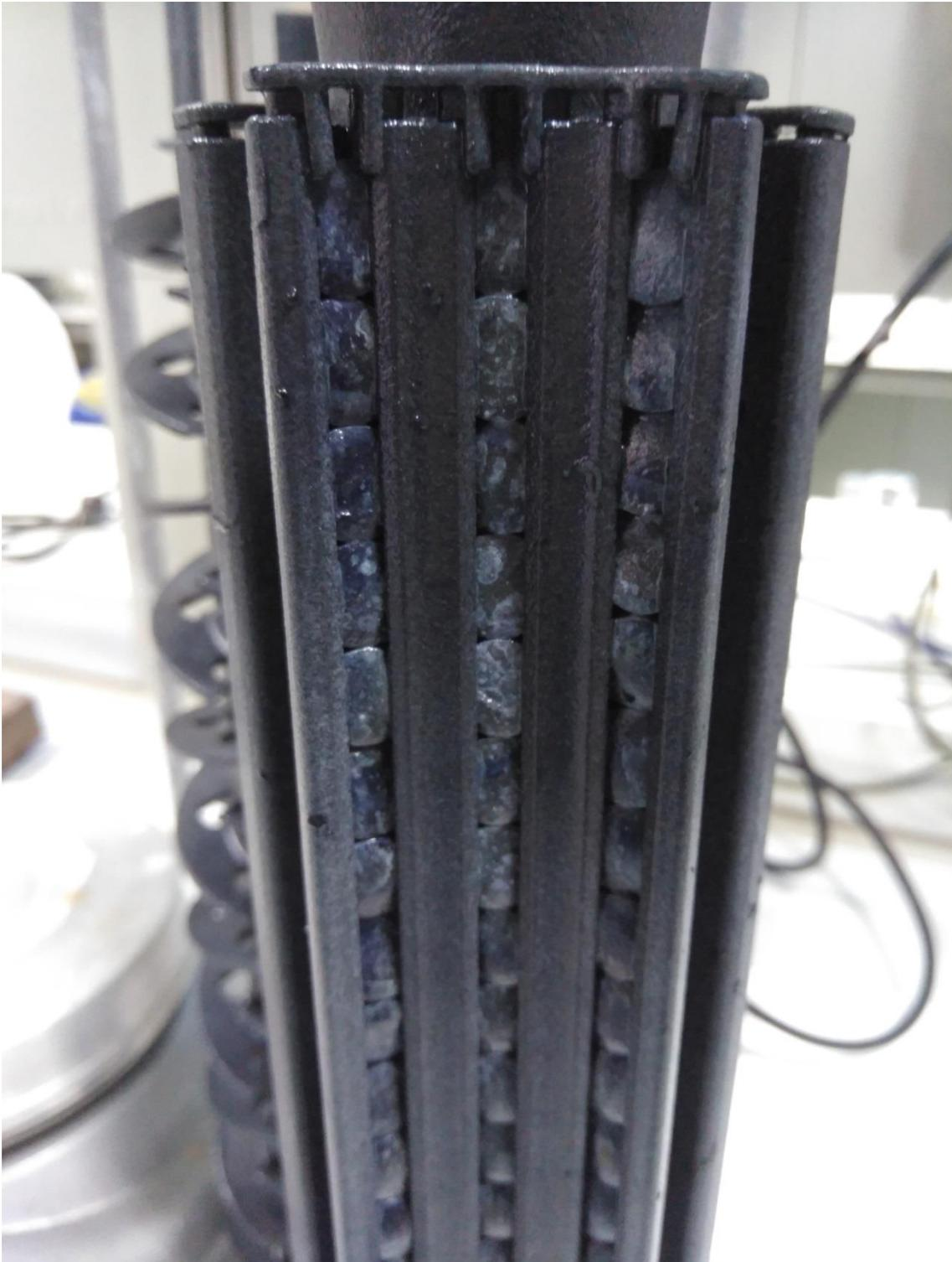
**Figura 17. Pastillas de ZnO/RGO colocadas en el reactor, después de realizar experimentos de fotocatalisis.**
