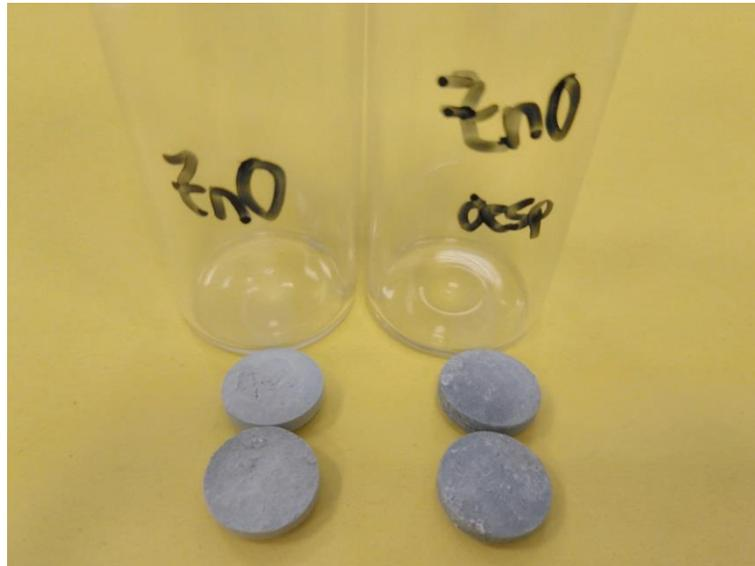
**Figura 15. Comparación de las pastillas de ZnO antes de realizar los ensayos de fotocatalisis (izquierda) y después de realizar los ensayos de fotocatalisis (derecha).**
