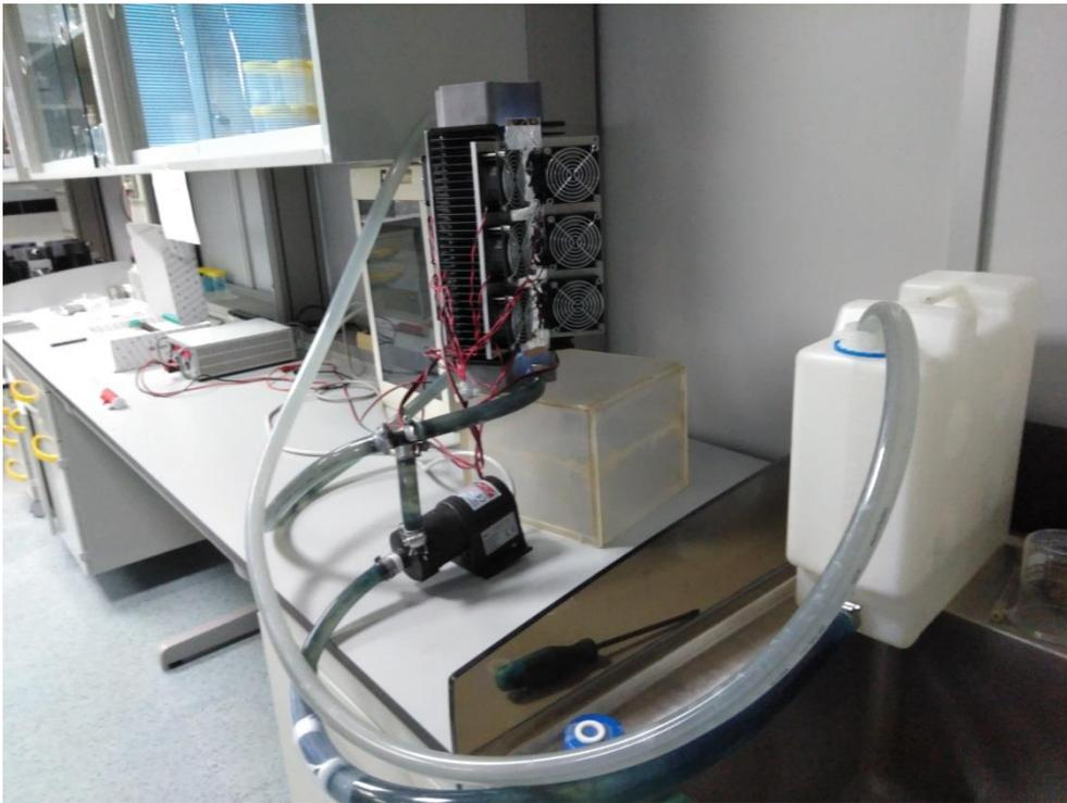
Figura 31. Fotografía del reactor en funcionamiento en el proceso de degradación del Diuron (15 mg/L).
